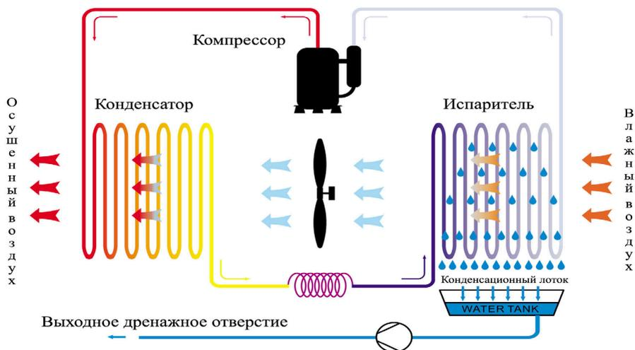
Относительная влажность воздуха постепенно сокращается до желательного значения относительной влажности, с помощью непрерывной циркуляции внешнего воздуха через установку.
