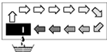
Поток воздуха охлаждается по пути сквозь/через испаритель-конденсатор, пока его температура не опускается ниже температуры точки росы. Водяной пар конденсируется и собирается в конденсационном лотке и дренируется.
